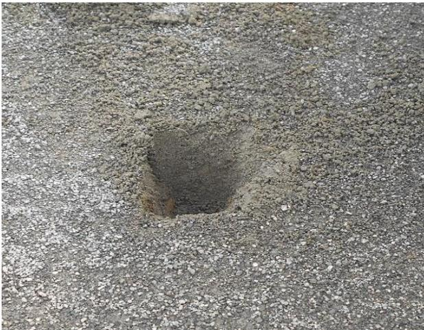
③適宜散水の浸透深さ確認
