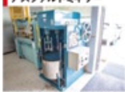
名物であり、アスファルト混合物を混ぜるための装置。試験で使われるアスファルトの配合は現場で決められるため、この装置は試験を行うために用意されている。中には用器の洗浄機も併設。
