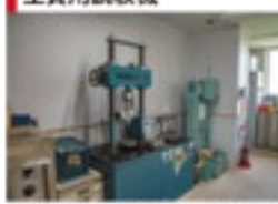
試験を行う場所の上層と下層を測定する装置。これは試験を行う際に下地となる土質の強度を測定するもので、CBR試験と併用している。この装置で測定した結果が、実際の舗装工事に活用されることもあり、重要な装置といえる。
