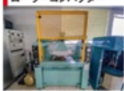
この装置を使ってのローラーコンパクション試験用の試験機も併設する。実際の道路舗装にこのローラーコンパクション機を室内で実用可能な状態で試験機も併設する。これで試験が完了する。
